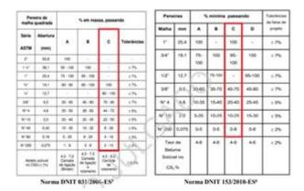
Com efeito, como analisado pela instrução técnica, observa-se que os percentuais estipulados nas respectivas normas (% em massa, passando), para a faixa "C", são distintos, portanto, a mesma composição de agregados, apresentará curva granulométrica diferente a depender do procedimento e norma utilizada, por se tratarem de especificações distintas.
